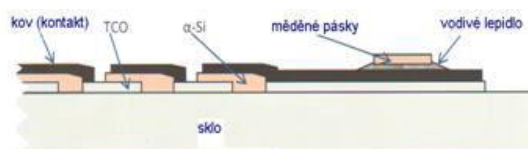
Obr. 20 Štruktúra konečného amorfného panelu [11]
