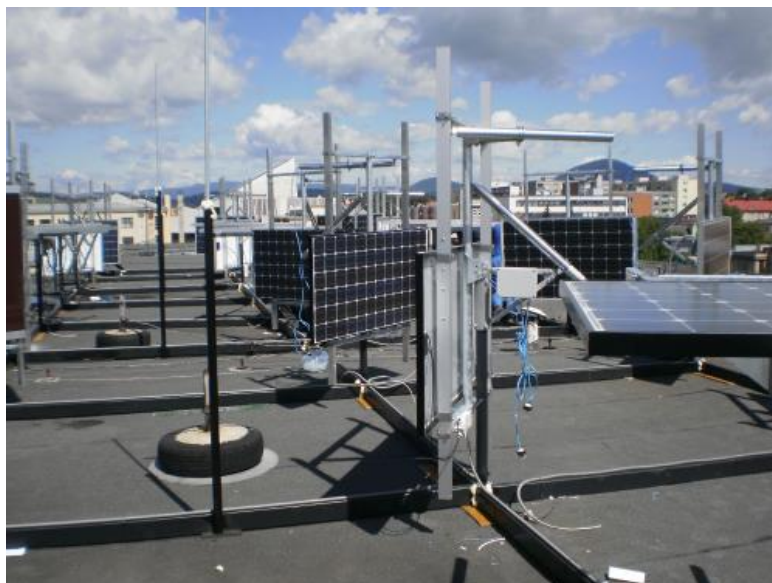
Obr. 32 Rôzne konštrukčné vyhotovenie a orientácia fotovoltaických panelov rôznym smerom – horizontálna orientácia, smery východ, juh, západ
