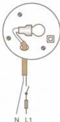
Obr. 17.2.5 c) Zapojenie svietidla triedy ochrany II. v sieti TN – S
