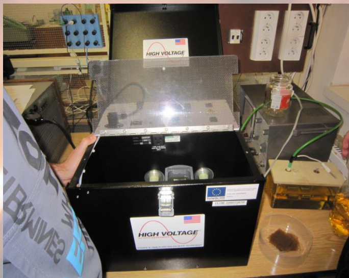
Prístroj na meranie elektrickej prieraznej pevnosti kvapalných dielektrík
