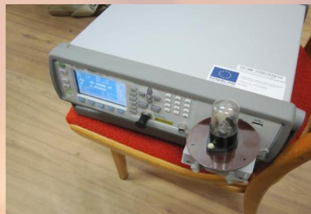
Prístroj na meranie frekvenčnej závislosti stratového činiteľa a permitivity izolačných systémov
