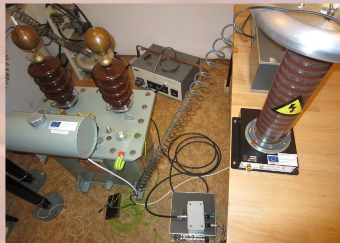
Vysokonapäťový skúšobný zdroj a kombinovaný delič na meranie vysokých napätí
