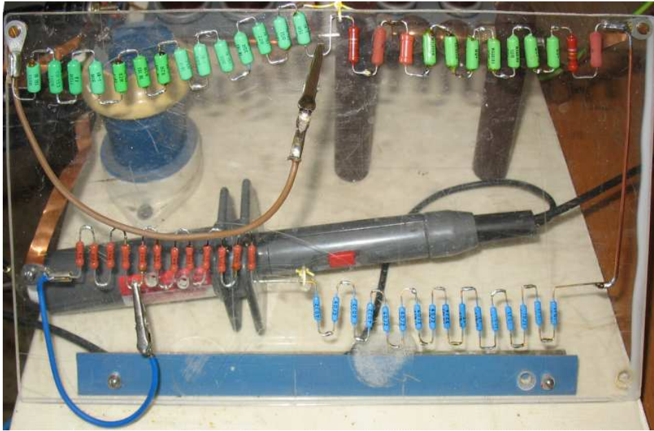
Obr. 8.1 Zapojenie rezistorov na prednom paneli generátora impulzov napätia
