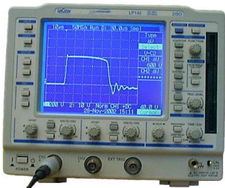
Obr. 7 Ochranná hladina pri skúšobnom napätí 1 kV
