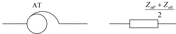
Obr. 4.5 Náhradná schéma dvojvinuťového autotransformátora
