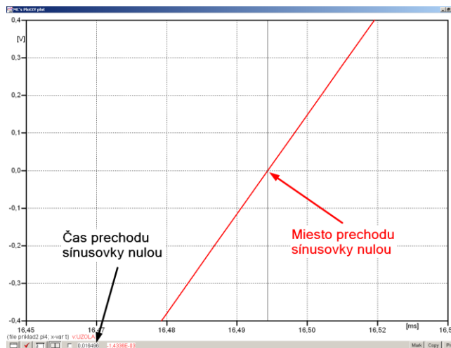
Obr. 21 Odčítanie času prechodu sínusovky nulou
