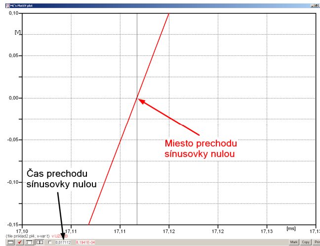
Obr. 30 Odčítanie času prechodu sínusovky nulou
